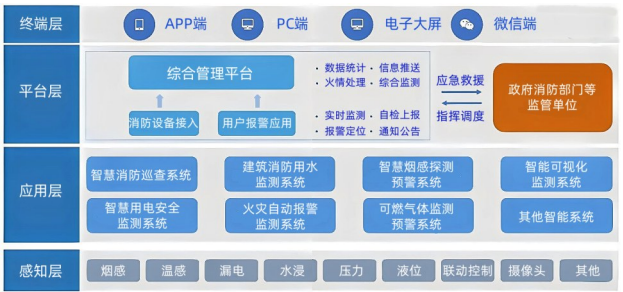
图2 物联网技术在智慧消防系统架构示意图
